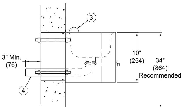
FIXTURE INTENDED TO PROVIDE AN EXTENDED WASTE OUTLET BEYOND THE REAR OF UNIT EQUAL TO WALL THICKNESS PLUS 3" MINIMUM.
